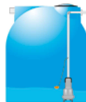
Bomba en paro
